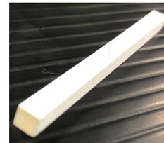
図 2: 白色ペイントで塗装された 4 mm×4 mm×64 mm プラスチックシンチレータバー
