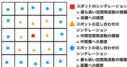
図 3: SH 波面センサーで得られるデータの模式図。アレイ状に並んだ複数のマイクロレンズによって複数の星像が得られる。これは望遠鏡の開口を実質的にアレイ状に分割していることに相当し、これらの選択の仕方によって空間スケールの異なる円環状の開口形状を作ることができる。
