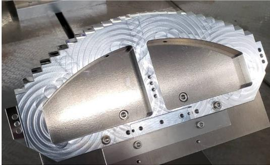
図 3: スリットミラーアレイの完成品。各段差の上面が球面鏡になっている。
