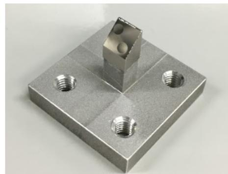
図 1: 加工後のワークピース。A5052 に Ni-P メッキを施したもの。
