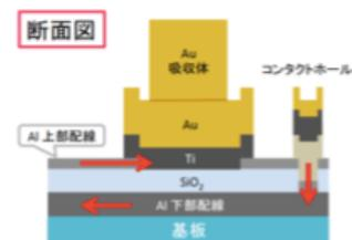
図 1: 積層配線の基板構造。
