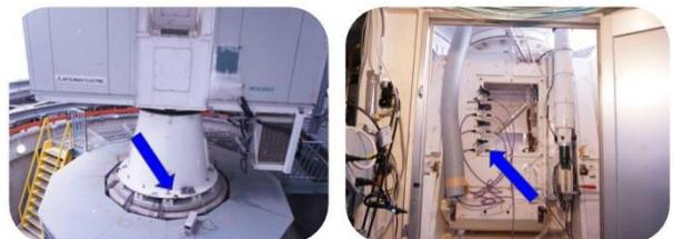
図 5: 傾斜計の設置 (アンテナ基礎と中間構造体)
