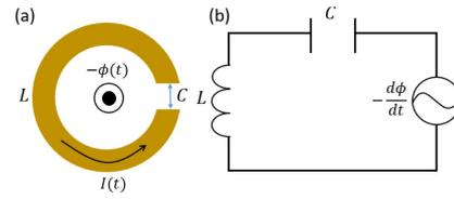
図 2: (a)SRR (b)LC 回路
