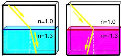
図 1: 光の経路 左図:正の屈折率 右図:負の屈折率
