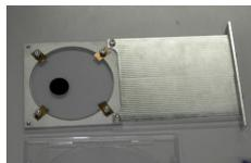
図 1: 1/100 部分減光フィルター。画像の黒い部分が減光領域となっている。フィルターは回転させることができ、4種類の向きに固定できる。
