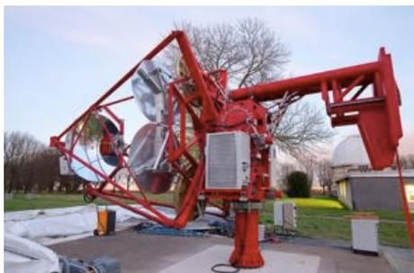
図 3: GCT プロトタイプの全体図。図中左側にある 1 枚構成の反射鏡が副鏡で、焦点面カメラと対にある (画像提供: CTA Consortium)。
