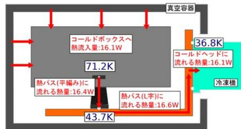
図 10: 実験値 (熱流入量と到達温度)
