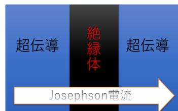
図 1: 絶縁体などの障壁が極めて薄い時、ジョセフソン効果により超伝導間に電流が流れる。この時の電流をジョセフソン電流という。
