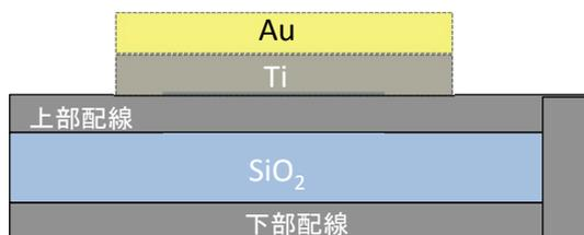
図 5: CMP 研磨積層配線基板
