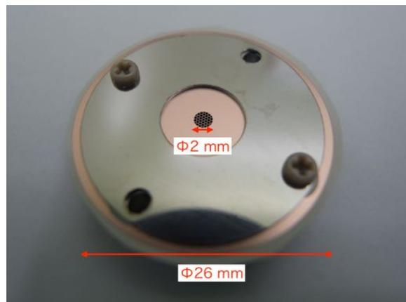
図 3: 製作した CCNS ホルダ。φ6 mm の大きな CCNS に φ2 mm の小さな有感領域を持つ GEM をかぶせている。中心部に見えるメッシュが GEM の有感領域部分。
