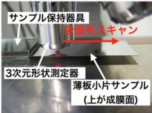
図 4: 薄板ガラス小片サンプルの形状測定の様子
