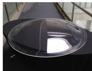
図 4: 直径 1.3 m、8 mm 厚の「アクリライト®」を球型に加工したもの [1]
