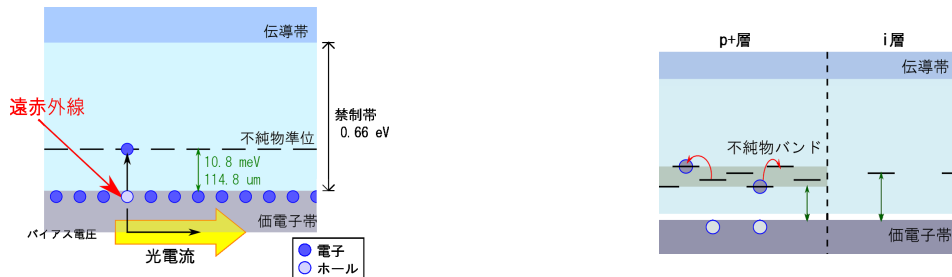
図 1 検出原理の概略図。左図が従来型 Ge:Ga、右図が BIB 型 Ge:Ga 検出器。
