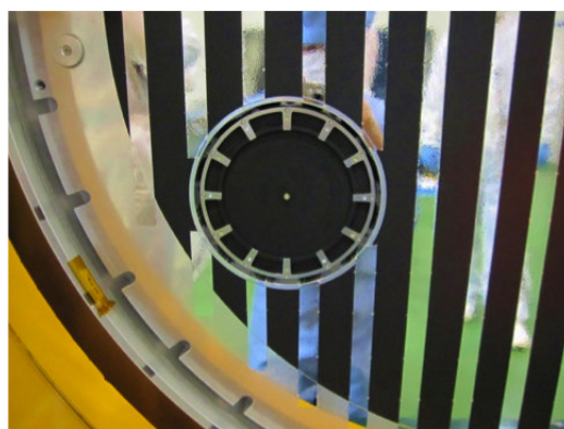
図 4: 左図は宇宙空間を航海する IKAROS の想像図、右図は実際に IKAROS に搭載された状態の GAP の写真、GAP は IKAROS の探査機本体の裏側に図のように配置され、常に反太陽方向を観測している
