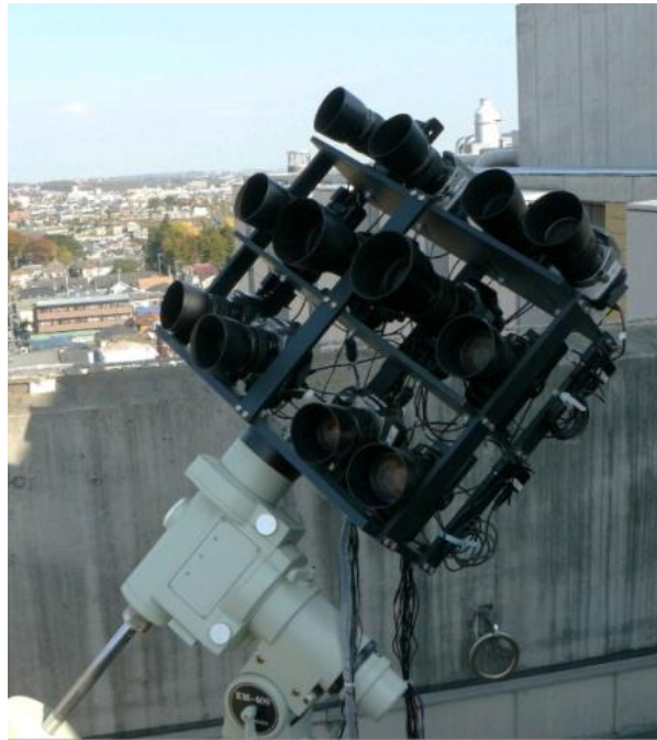
図2.1 デジタル一眼レフカメラを12台搭載したAROMA-W
