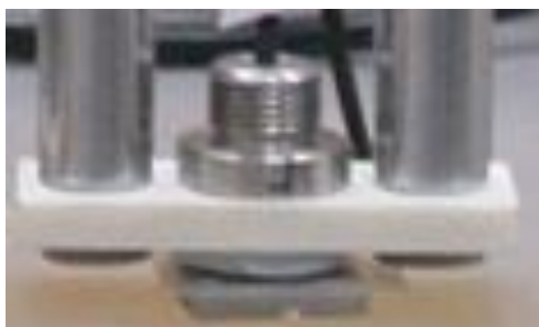
図 4 センサー(中央)と距離一定の状態を試験した様子
