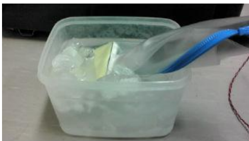
図7 氷水に沈めた状態で0°C付近の データをとった試験の様子
