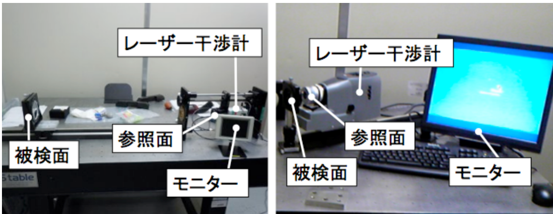
図5：OLYMPUS社製レーザー干渉計(写真左)とZygo社製レーザー干渉計(写真右)のコヒーレンス長測定実験の様子
