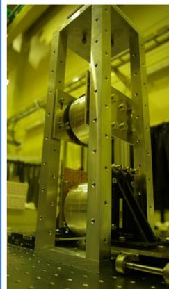
静電センサーとアクチュエーターの実験装置写真と模式図。
