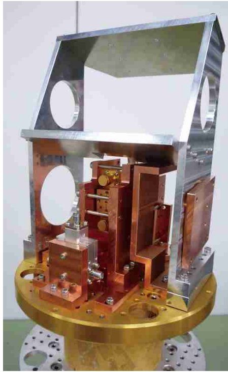
図(2.13) 設計を行った固定治具を取り付けた受信機
