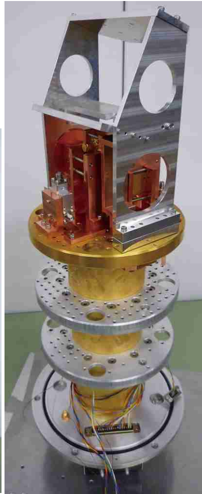
図(2.13) 設計を行った固定治具を取り付けた受信機
