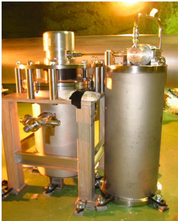
図 3 CLIO に搭載された冷凍機
