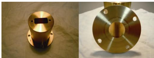
図 3.3-1 パーツ加工後の様子。D-sub フランジ (左) とフランジリング (右)。
